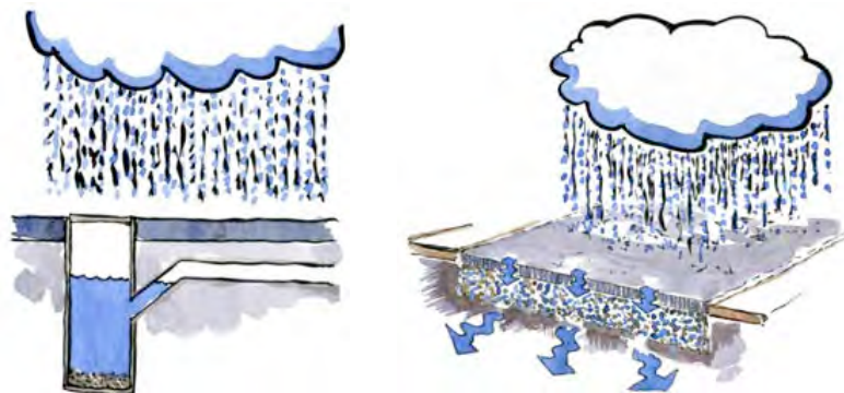
Figur 1. Traditionelt system til håndtering af regnvand på veje med kloaksystem for at dræne vandet væk (venstre side). NCC PermaVej®-konceptet med permeabel asfalt samt bærelag med stor porevolumen og høj gennemtrængelighed. Regnvandet løber direkte gennem asfalten og ned i det gennemtrængelige bærelag, hvor det langsomt siver ned i jorden (højre side). Et af mange eksempler på konceptet.
